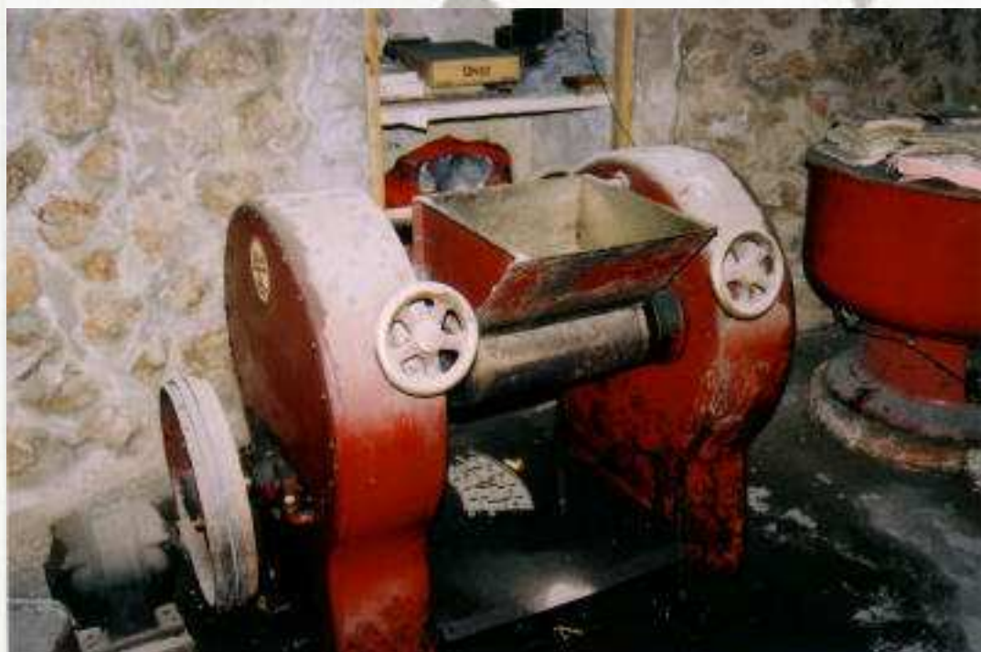
Màquina refinadora per a deixar ben fi el sucre, l'ametlla o qualsevol altre ingredient del procés d'elaboració de la xocolata.
