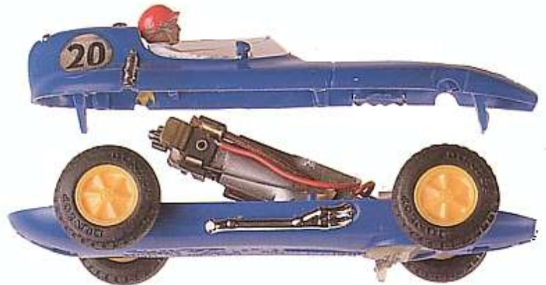
Detalles del motor eléctrico interno Triang y guía portatrencilla de nylon.
